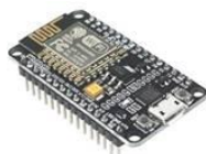
Fig.1: ESP 8266 NodeMCU Microcontroller Source : Khair, et al (2022)
